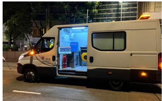
Fig. 8 - PFT Leak Location Test Van
