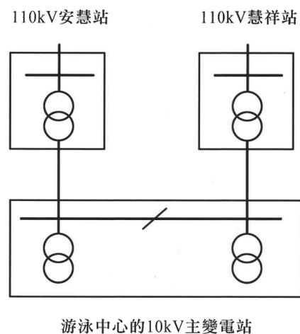
由圖可見，游泳中心的10kV系統相對比較簡單。考慮10kV系統的運行方式在第2.5.2部分中已有很詳盡的闡述，所以這裡僅作簡要說明。
