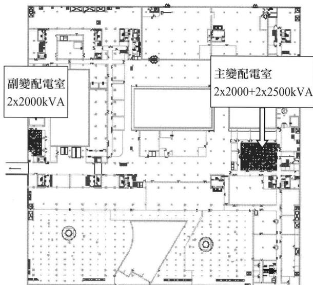
游泳中心主變電站。2路10kV進線來自安慧變電站及慧祥變電站。主變配電室內設有兩組變壓器，一組為就近水處理機房設備和各層照明、插座、通風、弱電機房設備等負荷供電；另一組主要為空調製冷負荷供電。副變配電室內設有一組變壓器為就近水處理機房設備和各層照明、插座、通風、弱電機房設備等負荷供電。根據北京奧運電力標準規定，國家游泳中心變壓器設計負荷率均不超過60%。
